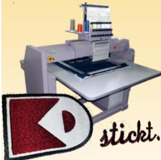
Das maschinelle Besticken von Textilien ist das älteste Textilveredelungsverfahren. Es zeichnet sich durch eine sonst unerreichte Haltbarkeit aus. Durch das Hinzufügen von Garn in die Textilstruktur können z.B. reliefartige Effekte erzeugt werden. Wir verwenden eine 15-Nadel-Maschine, so dass Stickmuster mit maximal 15 verschiedenen Garnfarben und eine Materialgröße von ca. 50 x 50 cm möglich sind.
